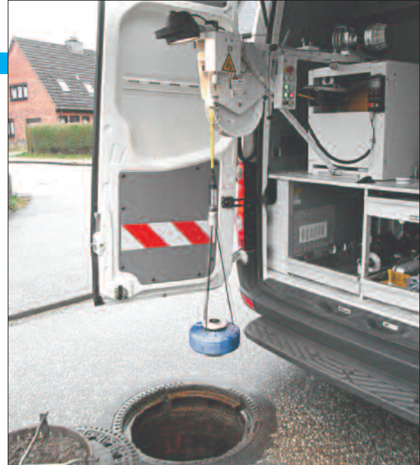
Schachtinspektionsfahrzeug mit Schacht-Scanner
