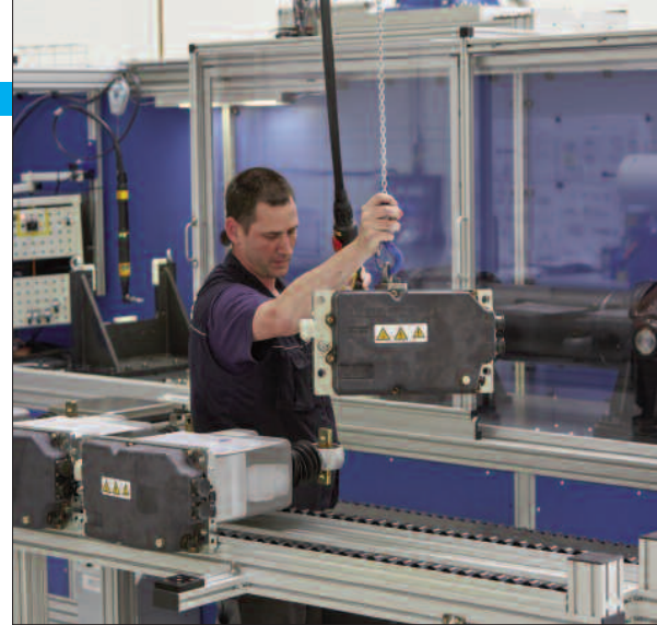
Hydraulik Aktuatoren im Testbereich
